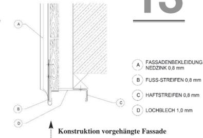
Konstruktion vorgehängte Fassade
