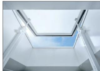
der Außenumgebung hat. Durch die 60 mm starke, wasserabweisende und aluminiumkaschierte PIR Dämmung werden optimalere Dämmwerte und verbesserte Isothermenverläufe erzielt. Der U-Wert des neuen thermisch getrennten Stahl-Aufsetzkranz inkl. PIR-Dämmung wird vom Hersteller mit U<sub>up</sub>=0,4 (W/m<sup>2</sup>K) angegeben, der U-Wert Dämmung beträgt 0,544 (WK/m<sup>2</sup>K).
