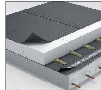
EPS-Dämmstoffsystem auf Beton: (v.o.n.u.) Wolfin GWSK, EPS Flachdach-Dämmplatten, Teroson EF TK 395 Dämmstoffklebstoff, Wittec Dampfsperrebahn AL-S, Beton.
