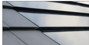
Das Planum PV Modul ist mit 1,5 m Deckbreite etwas kleiner als das G10 PV System, ermöglicht damit eine noch bessere Ausnutzung der Dachfläche, insbesondere bei Walm- und Zeldächern. Der Planum PV-Ziegel wird zudem nur mit drei Schrauben befestigt und ist daher noch schneller zu montieren. Nelskamp bietet für seine Solarziegel Planum PV eine Produktgarantie von 10 Jahren. Die Leistungsgarantien betragen über 10 Jahre 90% und über 25 Jahre 80% der Nennleistung.
